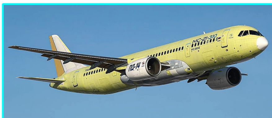
ПД-14 — турбо-вентиляторный двигатель для самолёта МС-21-300
