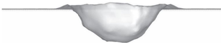
Рис. 1. Внешний вид кратера, образовавшегося в преграде при ударе кластером 5.8 нм
