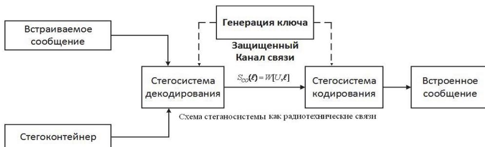
Рис. 1. Структурная схема стеганосистемы как радиотехнические связи
