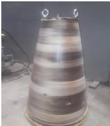
Рис. 2. Обточенный индуктор,
