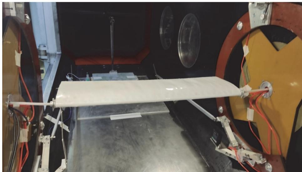
Рис. 4. Модель ВФС крыла в рабочей части трубы Т-324 ИТПМ СО РАН. Слева и справа подходят пневматические трассы для управления перепадом давления в нижнем и верхнем секторах
