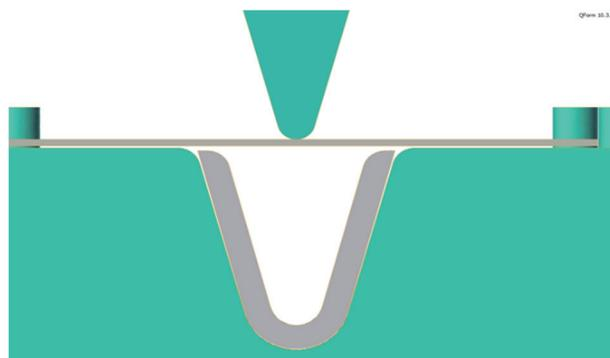
Рис. 2. Размещение упругого элемента в матрице
