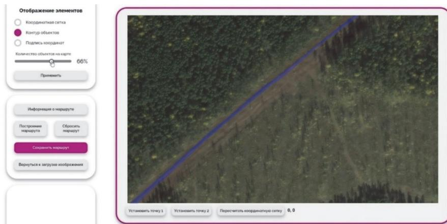
Рис. 3. Демонстрация сегментации трубопровода СНС синим полигоном
