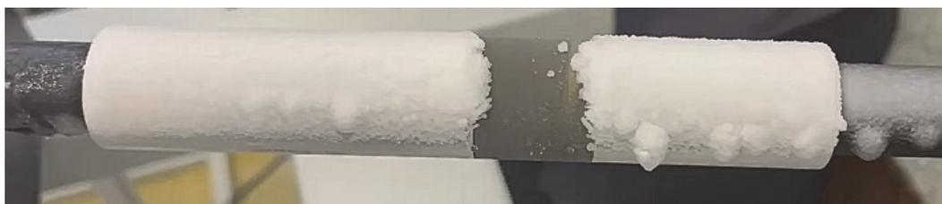
Рис. 2. Фотография поверхности трубы из сплава Д16Т после испытания в КАТ при температуре потока  $-15\text{ }^{\circ}\text{C}$
