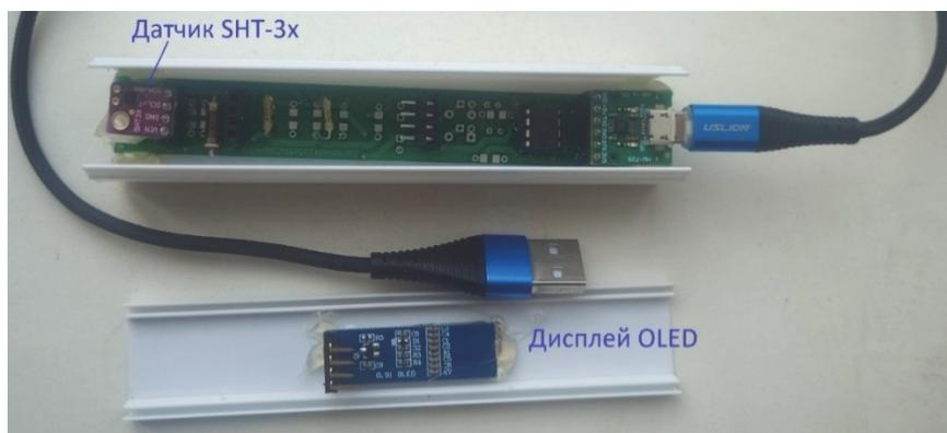
Рис. 5. Разобранная конструкция измерителя
