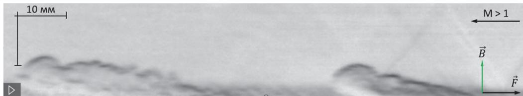
Рис. 2. Эволюция вихревых структур в зоне каверны низкой плотности, образованном при импульсном горении субмиллиметрового дугового разряда в магнитном поле
