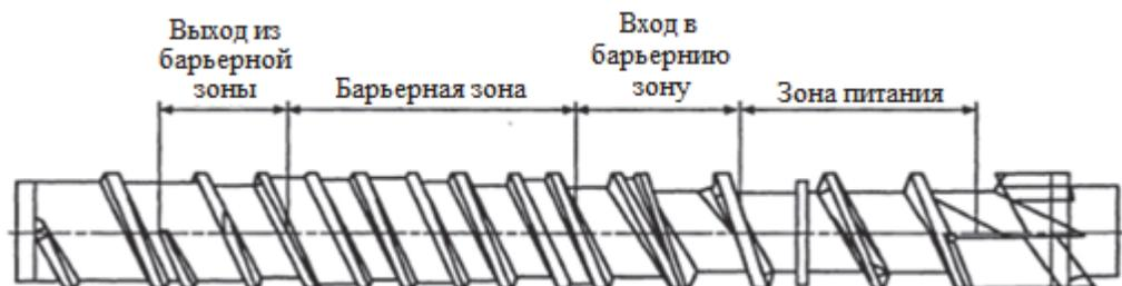
Рис. 3. Схема червячного шнека
