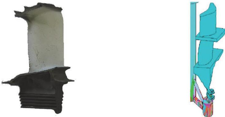
Рис. 1. Монокристаллическая лопатка авиационного двигателя (слева) и моделирование зеренной структуры детали после направленной кристаллизации сплава (справа)
