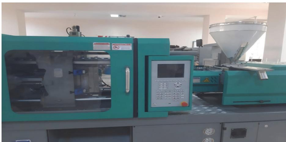
Рис. 1. Термопластавтомат TP-125
