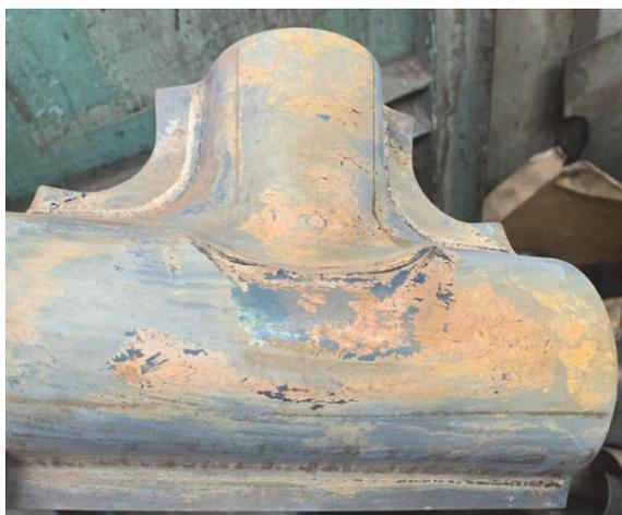
Рис. 3 Штамповка детали без разрушения
