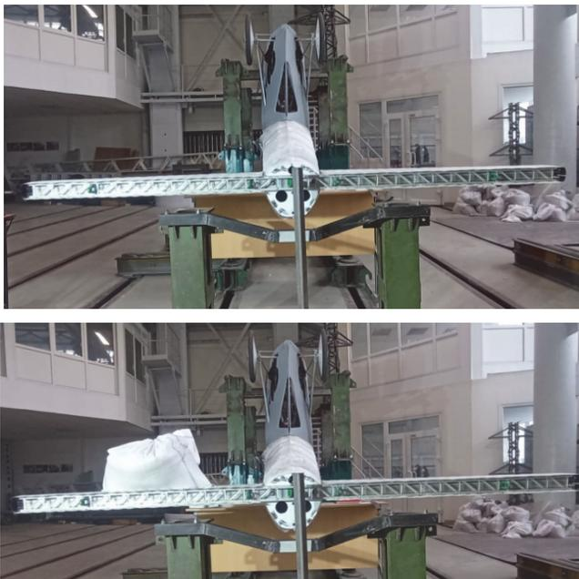
Рис. 3. Процесс нагружения хвостовой балки самолета «САРМА», сверху вид на конструкцию до нагрузки, снизу после приложения нагрузки
